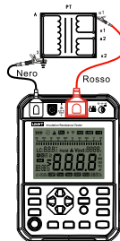
Fig. 10.2.2 Collegamento del test
