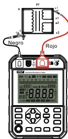
Fig. 10.2.2 Conexión de prueba
