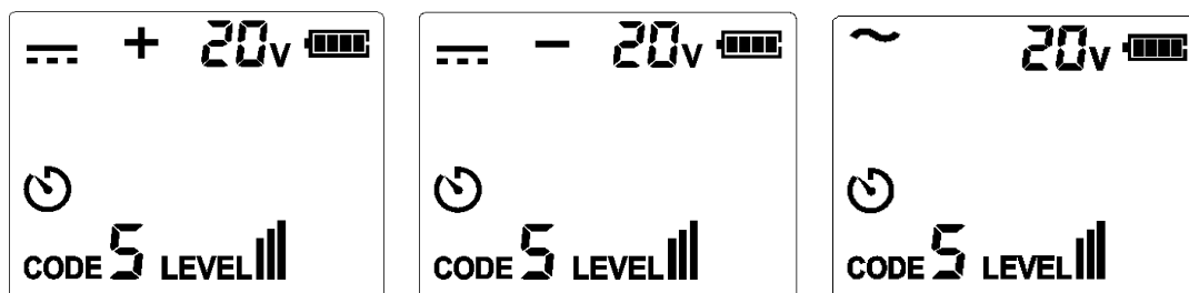
Figure 7.1.2b Tension inférieure à 30V
