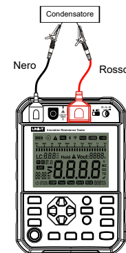
Fig. 9.3.3.1 Collegamento a filo della misura di capacità
