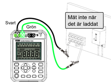
Bild 9.3.4.3 Trådanslutning vid mätning av låg resistans
