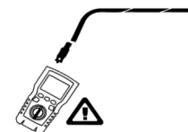
Bild 6.17 Spänning på koaxialkablage
